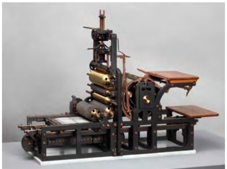
unten: Modell der ersten Zylinder-Schnellpresse, die nach Entwürfen von Friedrich Koenig 1812 in London gebaut wurde
